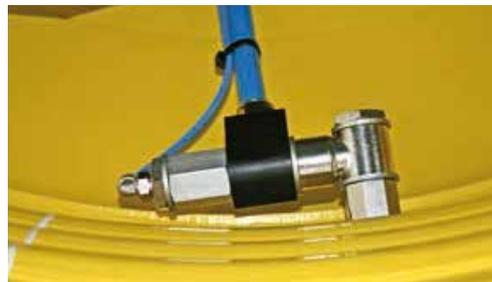
Das RDS wird mit einem Sicherheitsventil an die Druckluftbremsanlage angeschlossen, so daß stets 6,5 bar Vorratsdruck garantiert sind.
