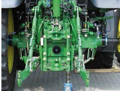
Langzeiterfahrungen seit 1991 beweisen eindrucksvoll, daß die Dichtungen der radialen 2-Leiter-Drehdurchführungen ein ganzes Schlepperleben halten. In der Felge wird ein schaltbares Radventil mit Rückschlagsicherung montiert, das bei einem eventuellen Leitungsabriß sofort schließt und den Reifen vor Druckverlust bewahrt.
