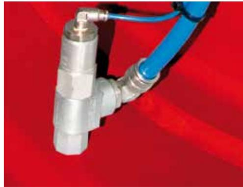
Das RDS wird mit einem Sicherheitsventil an die Druckluftbremsanlage angeschlossen, so daß stets 6,5 bar Vorratsdruck garantiert sind.
