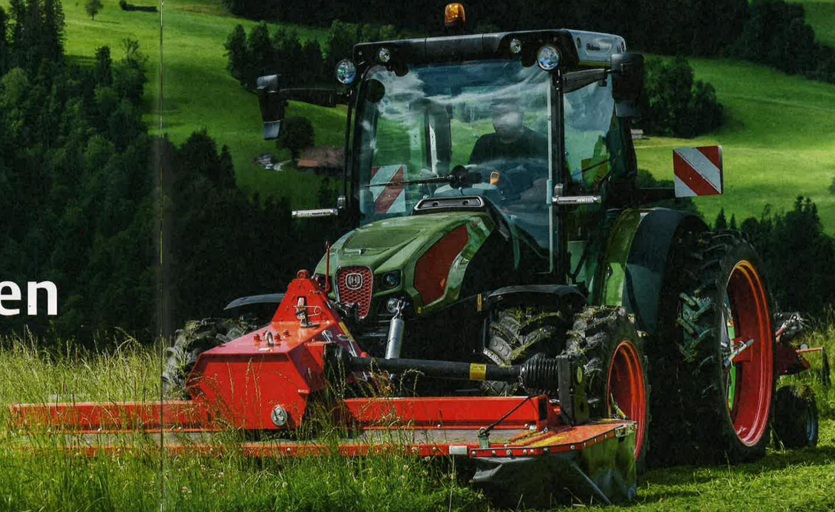
Zwillingsräder vergrößern die Auflagefläche und sind in steilem Gelände zu bevorzugen. Bild: SDF Schweiz AG
