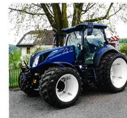
Das Doppelradsystem «Tractor-TWIN» ist für alle Traktoren(marken) geeignet.
