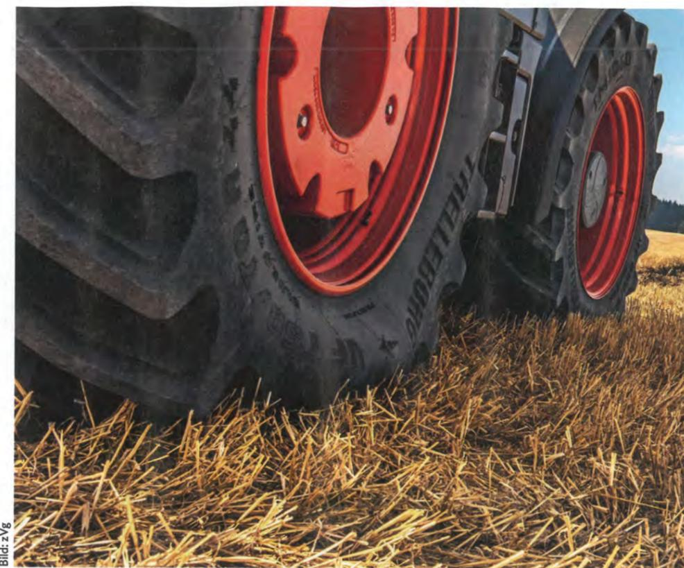
Selbst der beste Traktor benötigt einen gut eingestellten Reifendruck für eine gute Reifen-Boden-Verbindung, damit er seine Leistung und Technik ausschöpfen kann.
