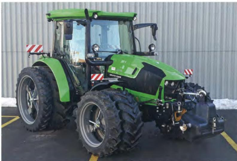
Doppelradssysteme gibt es in verschiedenen Varianten. Hier mit einem sogenannten All-Pass-Ring, mit dem das Rad in jeder Position montiert werden kann. Bild: zVg
