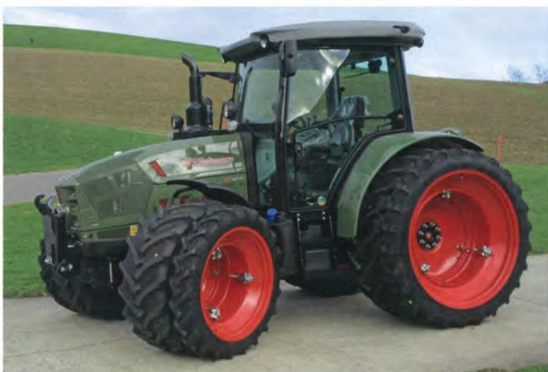
Mit dem Doppelradssystem Tractor Twin können Traktoren bis 390 PS mit Doppelrädern ausgerüstet werden. Bild: zVg
