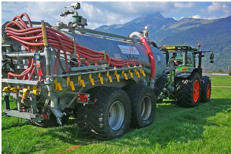
Traktor-Güllefass-Gespann, bei welchem die Bodendrücke gemessen wurden.
