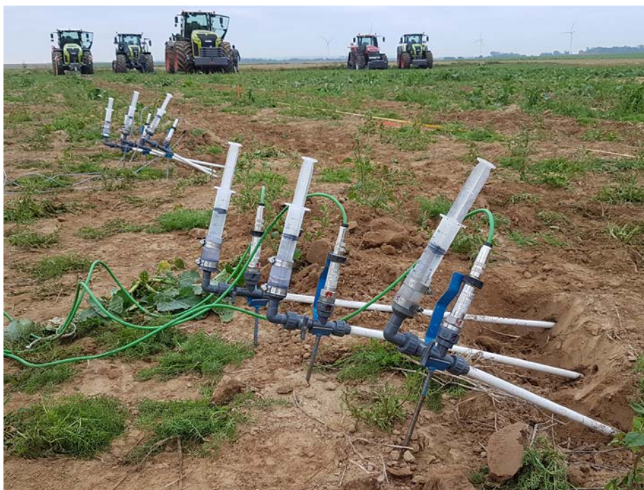
Typische Bodendruck-Messstelle mit drei Bollingsonden in 20, 40 und 60 cm Tiefe
