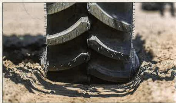
Die Aufstandsfläche der IF- oder VF-Reifen ist nicht nur breiter, sondern auch länger als bei der Standardbereifung.
