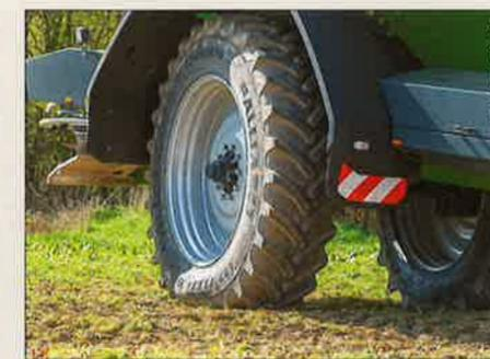
Längere Aufstandsfläche durch IF-/VF-Technologie – auch für Pflegebereifung.
