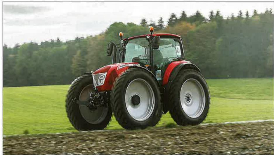
Die Hochradschlepper X5.45 HC von McCormick sind für Sonderkulturen ausgelegt, die in Dämmen wachsen, etwa Spargel oder Erdbeeren.
