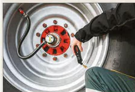
IF-/VF-Reifen ermöglichen eine Reduzierung des Luftdruckes um 20 % bzw. 40 %.
