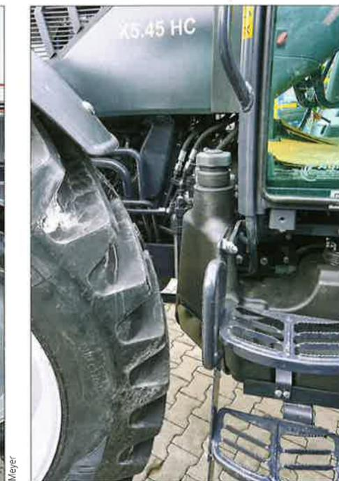
Tank und Aufstieg werden von Harlander für die großen Räder passend umgebaut.
