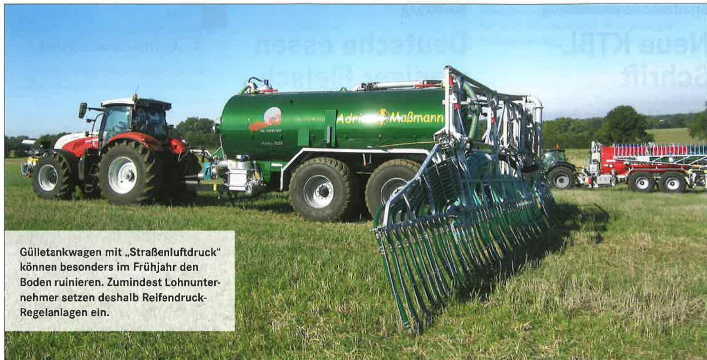
Gületankwagen mit „Straßenluftdruck“ können besonders im Frühjahr den Boden ruinieren. Zumindest Lohnunternehmer setzen deshalb Reifendruck-Regelanlagen ein.
