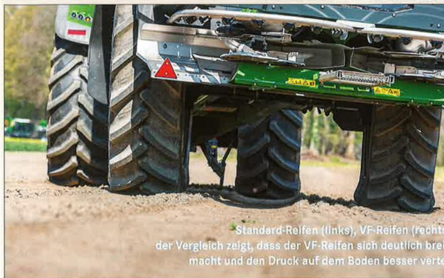
Standard-Reifen (links), VF-Reifen (rechts) – der Vergleich zeigt, dass der VF-Reifen sich deutlich breiter macht und den Druck auf dem Boden besser verteilt.
