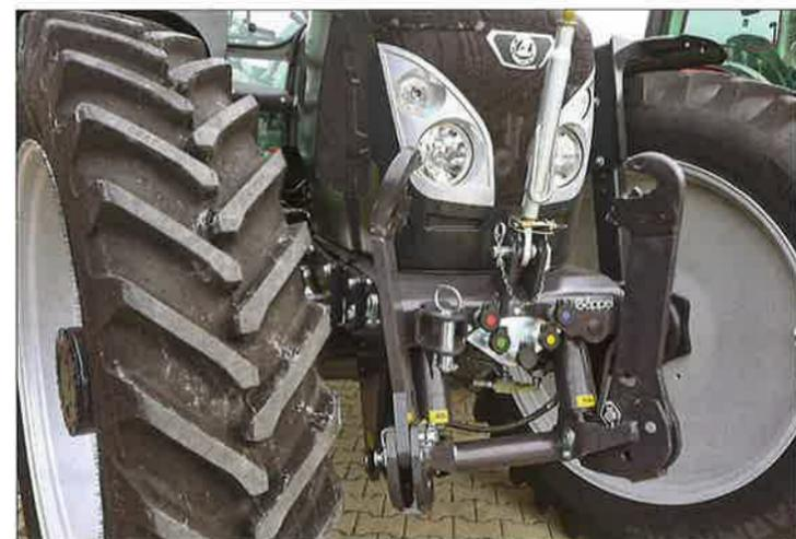
Das Fronthubwerk von Göppel hebt 3,5 Tonnen und ist durch einen Unterzug bis zur Hinterachse durchgestützt.
