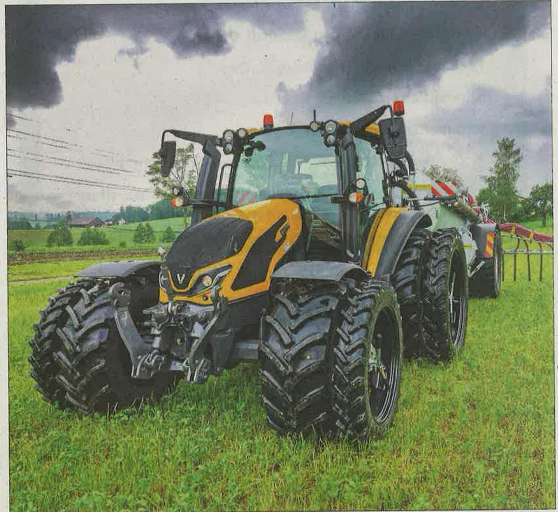
Mit der 34er-Bereifung ist der Valtra G 135 V sehr kompakt und wendig. Die Doppelräder unterstützen die Bemühungen, den Boden schonend zu befahren.
