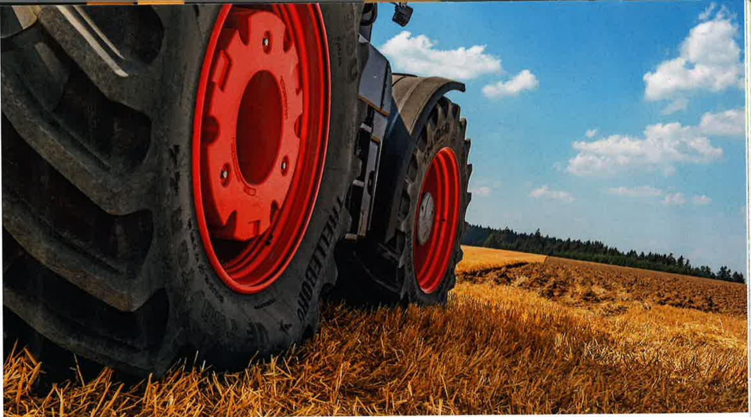
Mit einem optimierten Reifendruck kann der Traktor bis zu 15 Prozent mehr Leistung auf den Boden übertragen. Durch das Absenken des Luftdrucks erhöht sich die Reifenaufstandsfläche und zusätzliche Stollen verzahnen sich mit dem Boden. Bild: zVg
