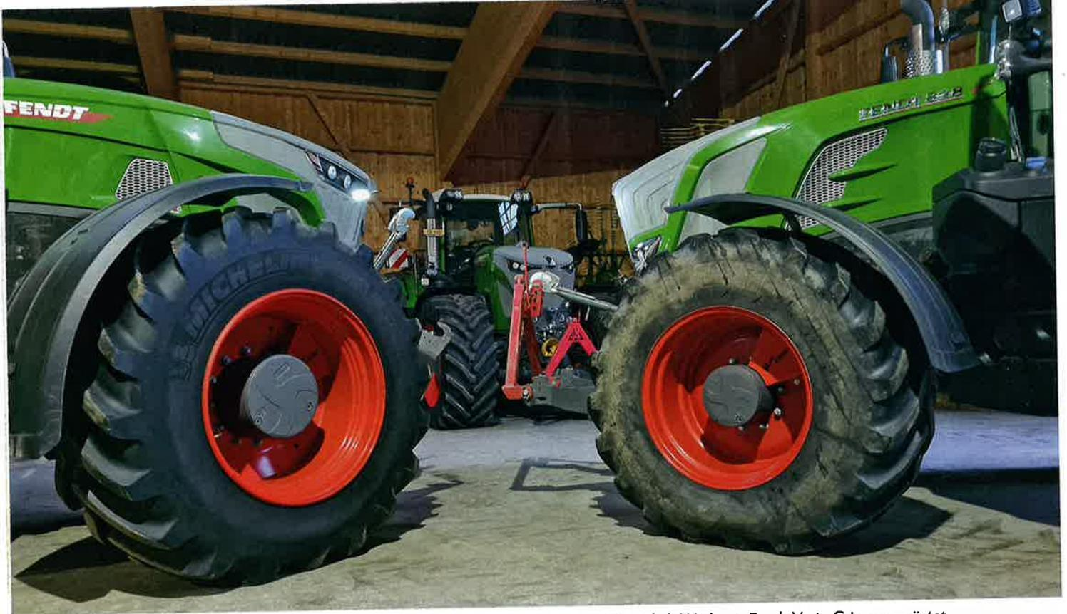
Die Grosstraktoren der Andrey und Schafer Lohnunternehmung AG sind ab Werk mit Fendt Vario Grip ausgerüstet. Die Luftleitungen sind mit Drehdurchführungen durch die Naben geführt und die Verstellung erfolgt am Terminal.
